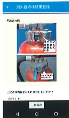
③点検実施画面
